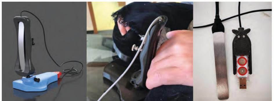
La main est positionnée pour faire contact avec une réglette en métal avec le doigt de Martial. La réglette est ainsi connectée à la Makey Makey et réagit au clic.
