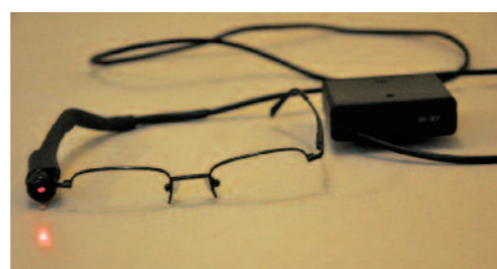
Première version du Kikoz, pointeur laser monté sur lunettes sans verre.
